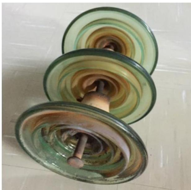
Figura 31 – Danos em isoladores devido a corrente de surto/descarga
