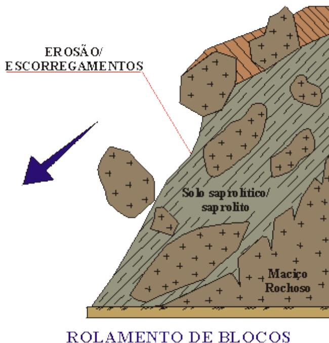
Figura 10: A ação de intemperismo no talude geralmente provoca este tipo de colapso (modificada de Bloom, 1988 apud Infanti Jr. & Fornasari Filho, 1998).
